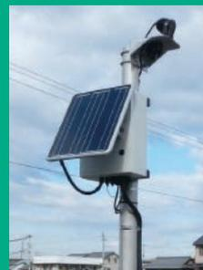
Pi-field(パイフィールド)は、電源やネット接続環境がない屋外でもラズパイでの環境モニタリング等が可能となる屋外稼動キットです。ラズパイや太陽光パネル、蓄電池、4G(LTE)通信モジュールなどの機材が防水ボックスに格納されており、本体だけでなく回線契約不要のSIMカードをバンドルしたプランも選択可能です。
